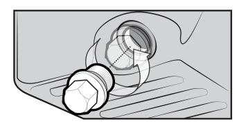
REMOVE THE FACTORY DRAIN PLUG FROM YOUR OIL PAN.
